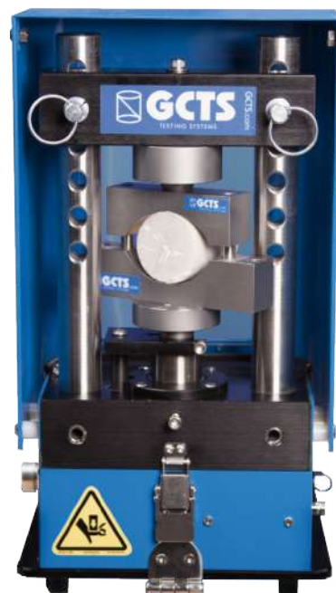
Ensayo de tensión indirecta (ensayo brasileño)
